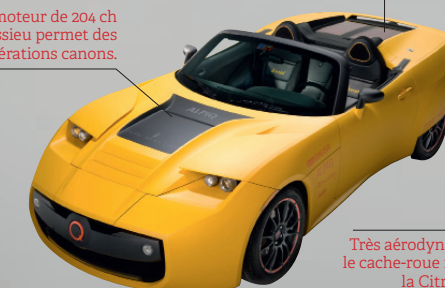
Un panneau solaire sert à alimenter les instruments de bords et la radio.
